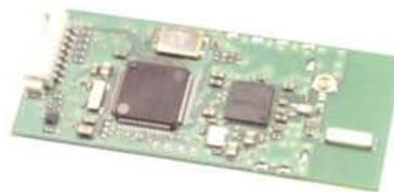
Für die Module ist als Software sowohl eine IEEE802.15.4-interoperable MAC- und PHY-Implementierung vorhanden. Um die Module ohne weiteren Aufwand in Betrieb zu nehmen, steht auch ein AT-Kommando-Parser zur Verfügung. Dieser findet auch Anwendung bei der Kommunikation mit dem PC, für den mit der „Wireless Management and Configuration Suite“ (WMCS) ein leistungsfähiges generisches Frontend auf dem PC die einfache Inbetriebnahme und Überwachung von IEEE802.15.4-Netzwerken erlaubt.
